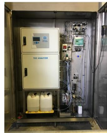
*Hach BioTector B7000i Dairy mit Vakuum Venturi Probenahme bei MEGGLE in Wasserburg*
